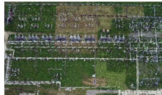
Обработка результатов аэрофотосъёмки при обследовании ЛЭП производится стереофотограмметрическими методами. Принцип стереоскопического эффекта, основанный на получении двух изображений одного и того же пространства с нескольких точек, смещённых на расстояние, позволяет получить стереоскопическое изображения. Снимки, содержащие одинаковый участок, образуют стереопару. По результатам съемки ЛЭП производятся измерения стереопар фотоснимков.
